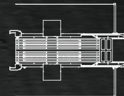
module de sortie avec convoyeur
